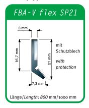
FBA-V flex SP27 3 mm\_ mit Schutzblech with protection 7,3 mm Länge/*Length*: 800 mm
